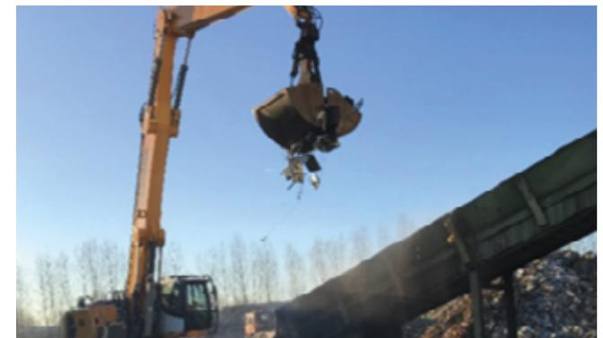
Aufgabe der Elektroaltgeräte auf das Zuführband der MV-ZS-Anlage
