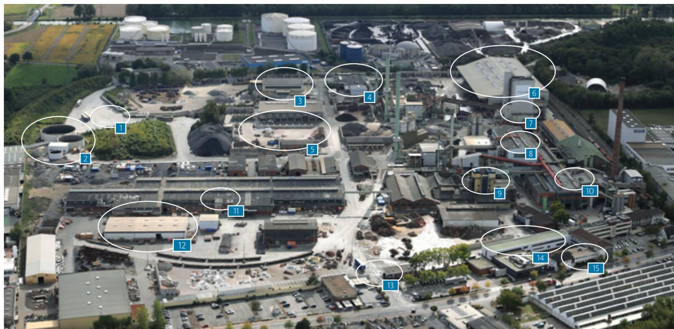
1 Werkszufahrt Süd mit Lärmschutzwall 2 Regenwasserrückhaltung 3 Materialvorbereitung 4 Probenahme 5 E-Schrott-Aufbereitung 6 Lagerhalle 4 7 KRS 8 TBRC 9 Laugerei 10 Anodenhütte 11 Kupferelektrolyse 12 Kathodenlager 13 Werkszufahrt Kupferstraße 14 ATASI 15 Verwaltung
