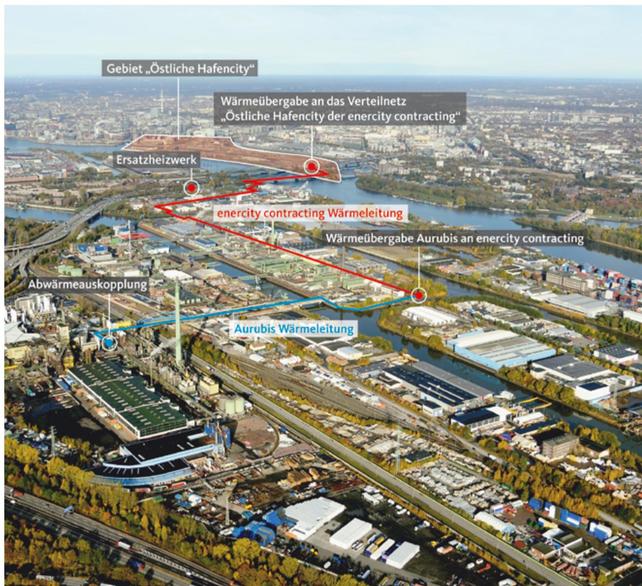
Die Wärme ist CO<sub>2</sub>-frei. Sie entsteht ohne Einsatz fossiler Brennstoffe als frei werdende Reaktionswärme bei der Schwefelsäureherstellung. Durch diese zukunftsweisende Abwärmenutzung können bis zu 20.000 t CO<sub>2</sub> jährlich eingespart werden. Gleichzeitig wird die Elbe entlastet: Mit der Auskopplung der Wärme werden ca. 12 Mio. m<sup>3</sup> Kühlwasser pro Jahr nicht mehr benötigt.
